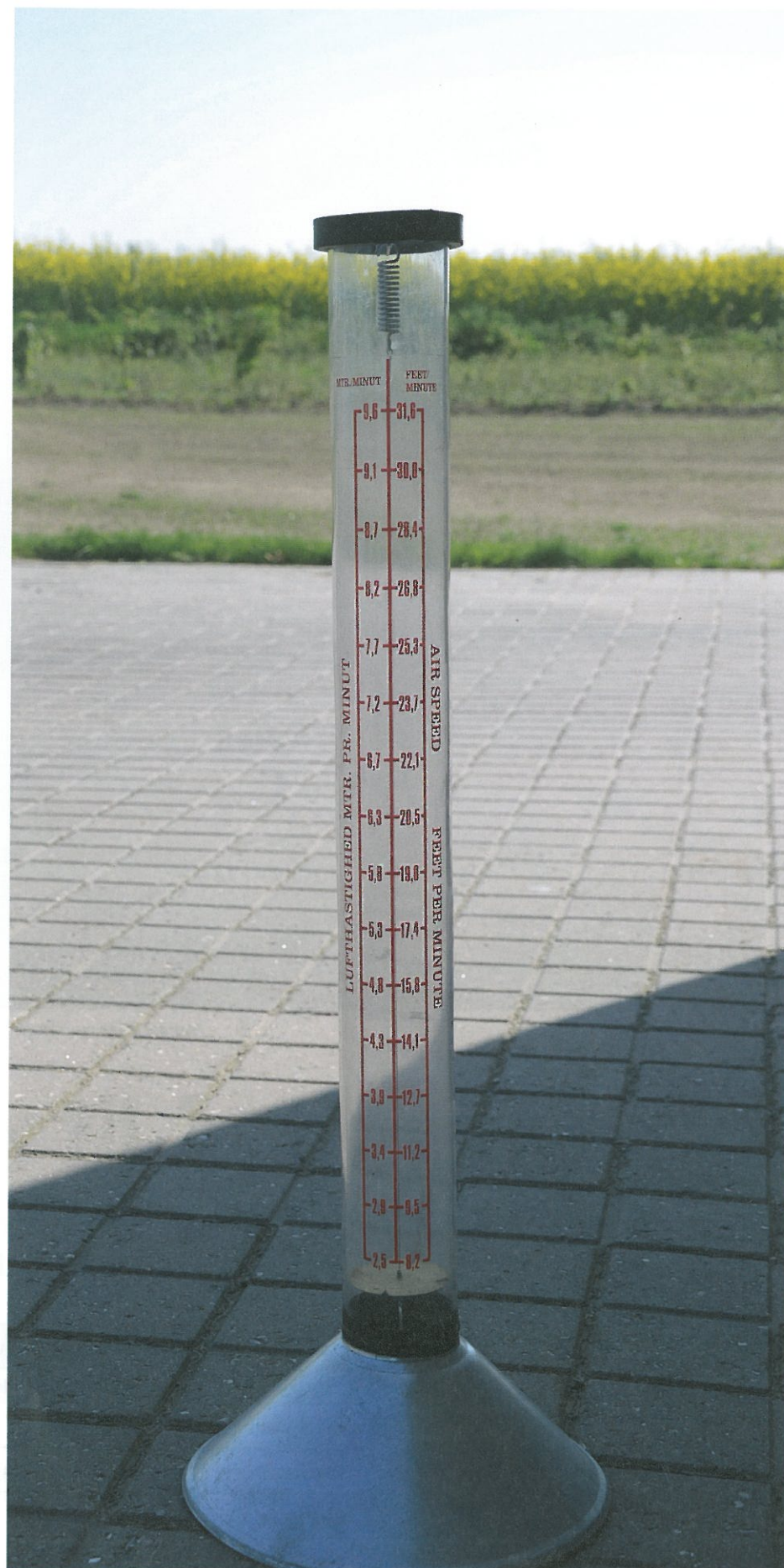
Et flowmeter er et nyttigt redskab til kontrol af luft hastigheden.
